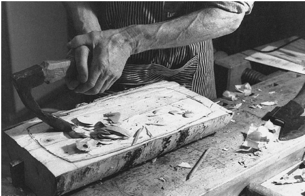
Nach dem Aufzeichnen der Innenform beginnt das Aushöhlen. Beim zweihändigen Griff liegt die eine Hand auf der anderen.
