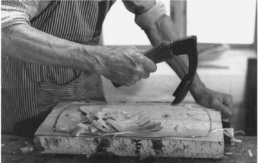
Bei einhändigem Griff stützt sich die andere Hand auf das Werkstück.
