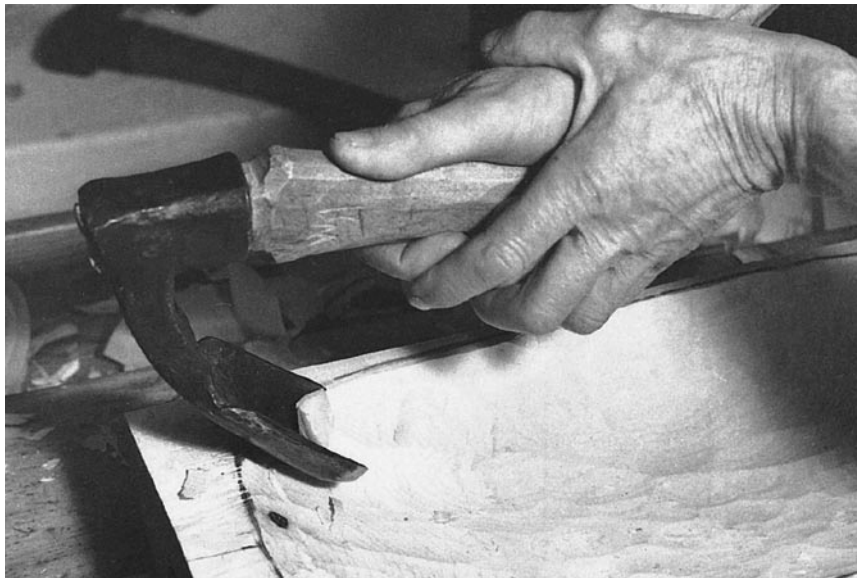
Die Arbeit mit dem Dechsel ist spannend und faszinierend, und man kann effektiv und zugleich präzise arbeiten. Es erleichtert das Glätten, wenn man so sauber wie möglich mit dem Dechsel vorgearbeitet hat.
