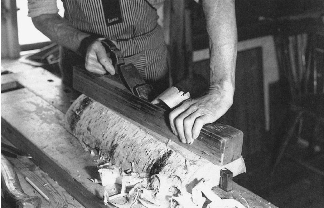
Die Unterseite wird mit der Rauhbank gehobelt.
