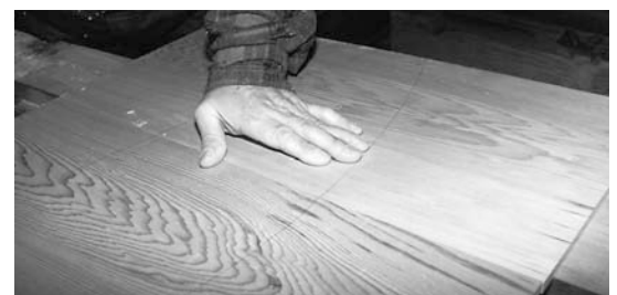
13–14 Hier wird die Flucht der Kanten geprüft
