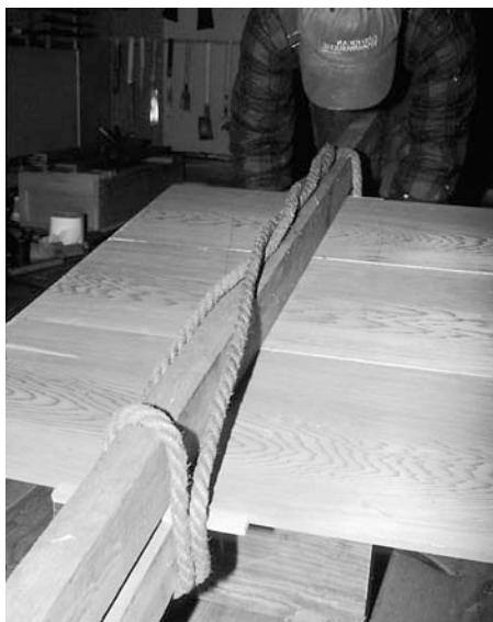
18 Die Bretter werden mit einem Seil zusammengebunden. Dabei sollten die Kanten fest aneinanderliegen
