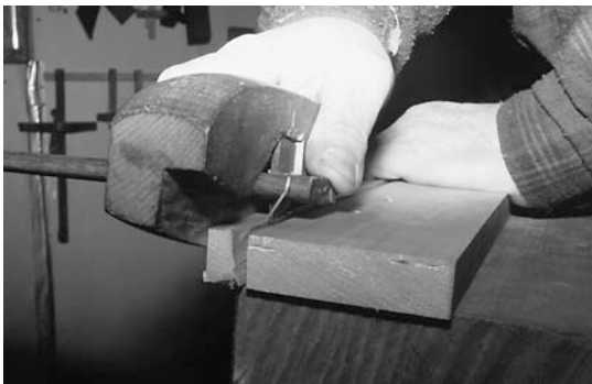
23 Der Kumiko wird mit dem Streichmaß vom Brett abgetrennt
