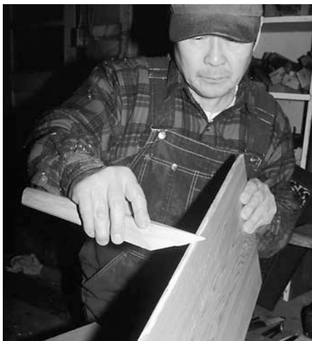
15–17 Auf die Kanten der Bretter wird Leim aufgebracht
