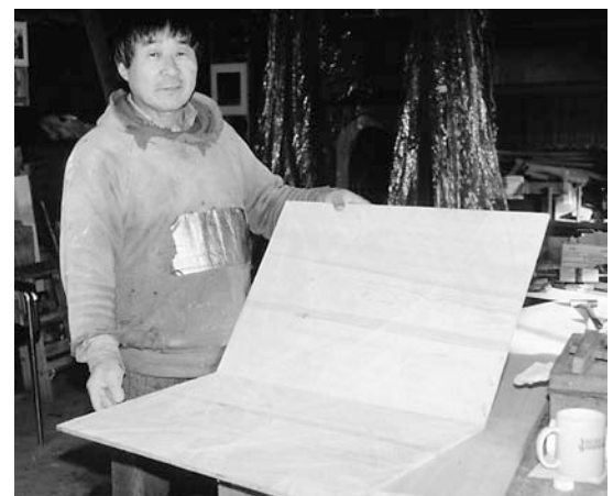
7–10 Die Füllung wird mit einer Handsäge in zwei Teile gesägt. Sie hat die Abmessungen 460 mm × 760 mm × 22 mm
