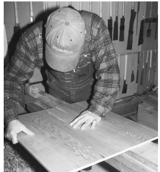
11 Hobeln Sie die Kanten der Füllung mit einem Fügehobel mit speziell konfigurierter Hobelsohle, bevor die einzelnen Bretter verleimt werden. Zur Erzeugung einer leichten Krümmung an der Kante drücken Sie den Hobel am Anfang des Arbeitsgangs nur leicht nieder, in der Mitte stärker, und zum Ende hin lassen Sie den Druck allmählich nach
