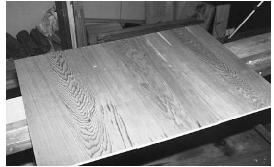
12 Vor dem Hobeln der Kanten werden die drei Bretter nebeneinandergelegt und in der Mitte mit einem großen X gekennzeichnet. So ist die ursprüngliche Position jedes Brettes immer zu erkennen
