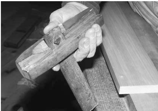
22 Das Streichmaß hat einen gekrümmten Block, der es ermöglicht, mit jedem Arbeitsgang tiefer zu schneiden
