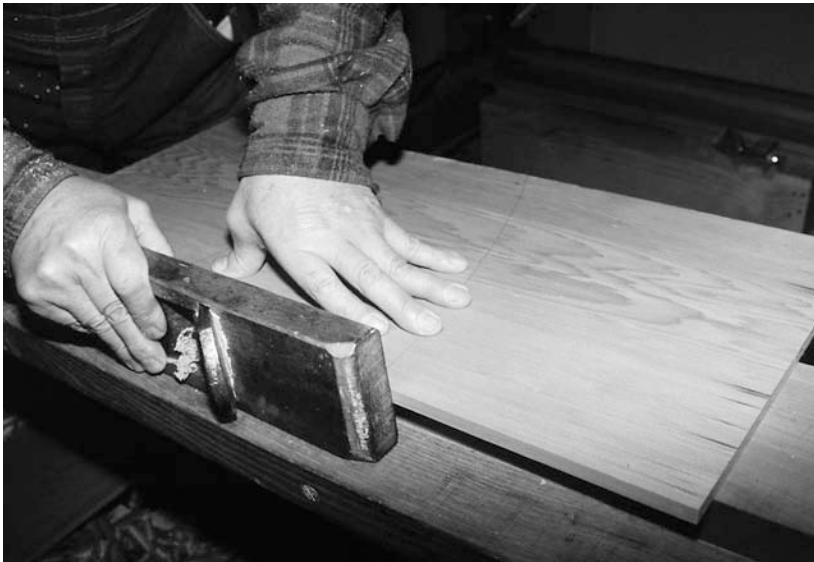
11 Hobeln Sie die Kanten der Füllung mit einem Fügehobel mit speziell konfigurierter Hobelsohle, bevor die einzelnen Bretter verleimt werden. Zur Erzeugung einer leichten Krümmung an der Kante drücken Sie den Hobel am Anfang des Arbeitsgangs nur leicht nieder, in der Mitte stärker, und zum Ende hin lassen Sie den Druck allmählich nach
