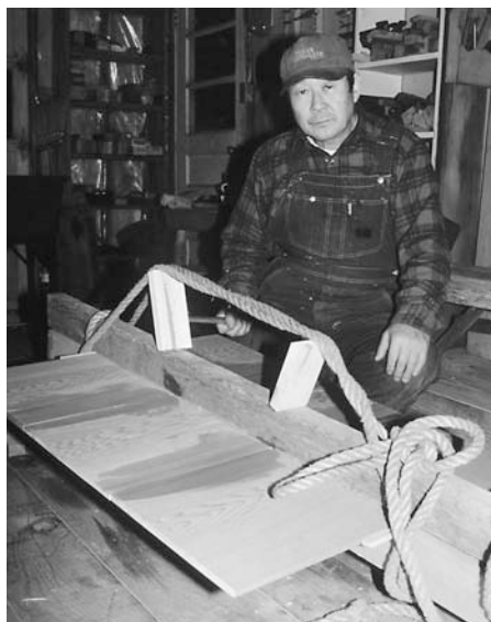
20 Das verleimte und verzurrte Brett muß nun trocknen
